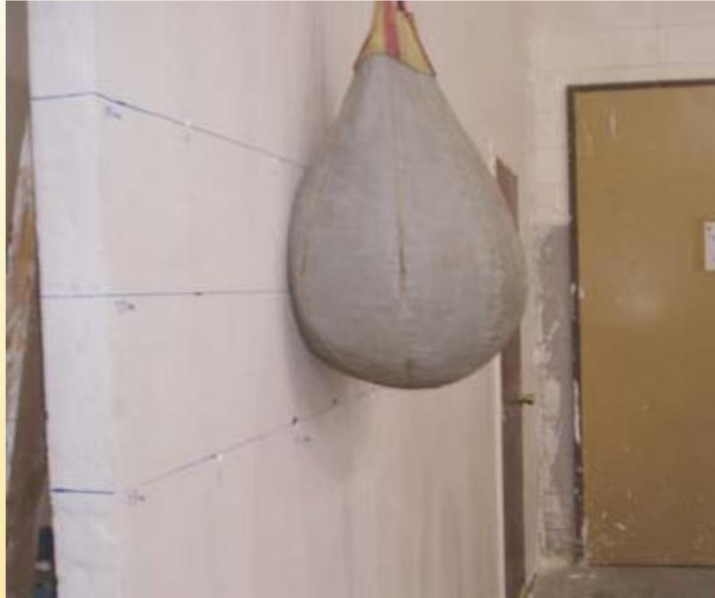
Impacto con un saco de 50 kg liberando una energía de hasta 300 Nm
