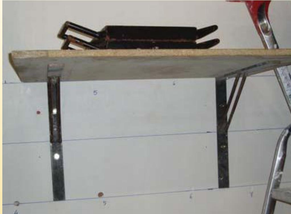
Aplicación de una carga de hasta 1.000N a 30cm de la pared sobre una estantería de forma continua durante 24h
