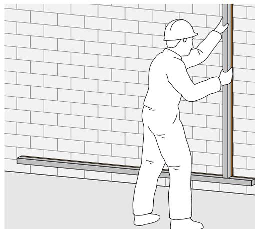
Figura 7.3. Colocación de la mira para la ejecución de la maestra del extremo derecho.
