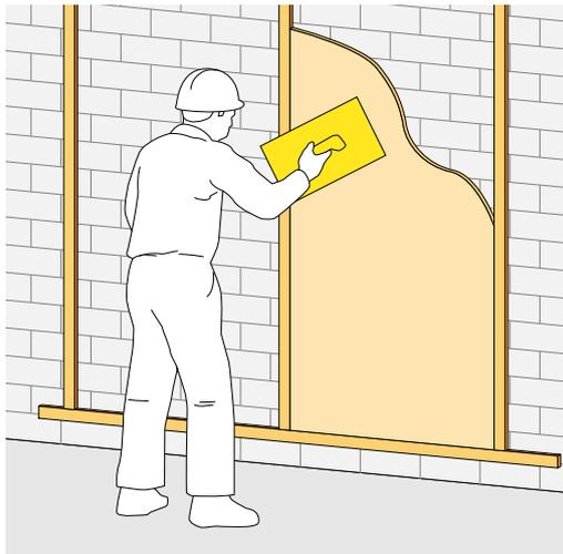
Figura 9. Ejecución de los cajones: tendido del yeso entre maestras.
